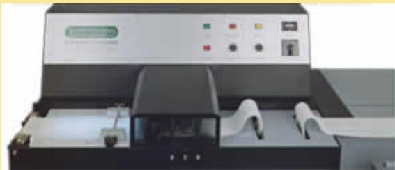
La saldatura del telo avviene tramite l'operatore, che provvede ad inserire il fondo e la testa del telo nell'apposito dispositivo.
