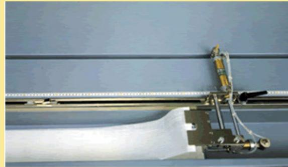
La lunghezza del telo viene impostata manualmente dall'operatore fissando la pinza di presa del tessuto alla misura desiderata.
